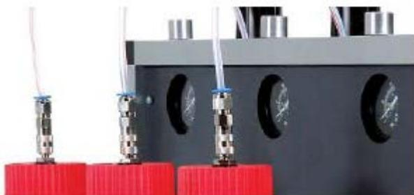
**XPREP-3: эффективная фильтрация при методе встряхивания пробы или колоночной адсорбции. Пробоподготовка образцов для определения АОХ и ТОХ.**
